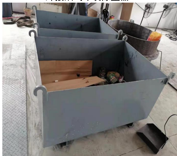
一般固体废弃物堆放框
